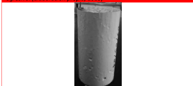
Figura 1 Probeta acondicionada antes de su inmersión en medio agresivo. (Elaboración propia, 2013)
