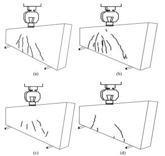
(c) (d) **Figure 6.** Cracks pattern; a) control beam, b) 10% PET-R, c) 30% PET-R, d) 60% PET-R.
