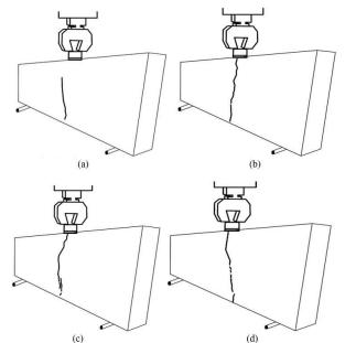
(c) (d) **Figure 15.** Cracks pattern; a) control beam, b) 0.5 % PP, c) 1.5% PP, d) 3.0% PP.
